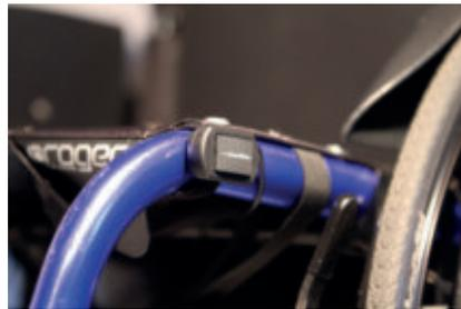
**Steuerelemente:** Die Bedientaster haben identische Funktion und sollten gut erreichbar nahe den Rädern montiert werden
