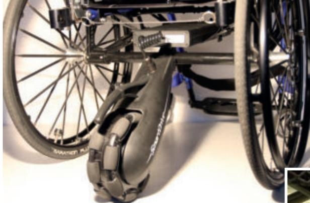
**Energiepaket: Der Antrieb ist mit wenigen Handgriffen montiert und einsatzbereit**
