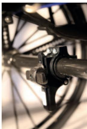
**Schnellkupplung: In die Achsmanschette wird die Antriebseinheit eingehängt**
