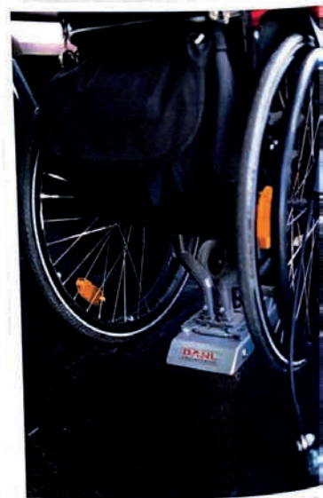
Bügeleisen: Die massive Stahlplatte sorgt für Sicherheit und ist im Alltag nicht im Weg
